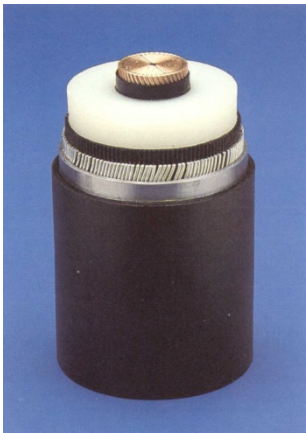
400 kV PE Cable in 1986
