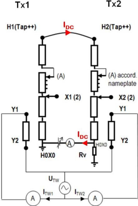
FIG. 1 BACK-TO-BACK TEST SETUP.
